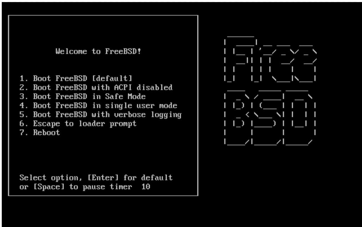
图 1. FreeBSD Boot Loader Menu
